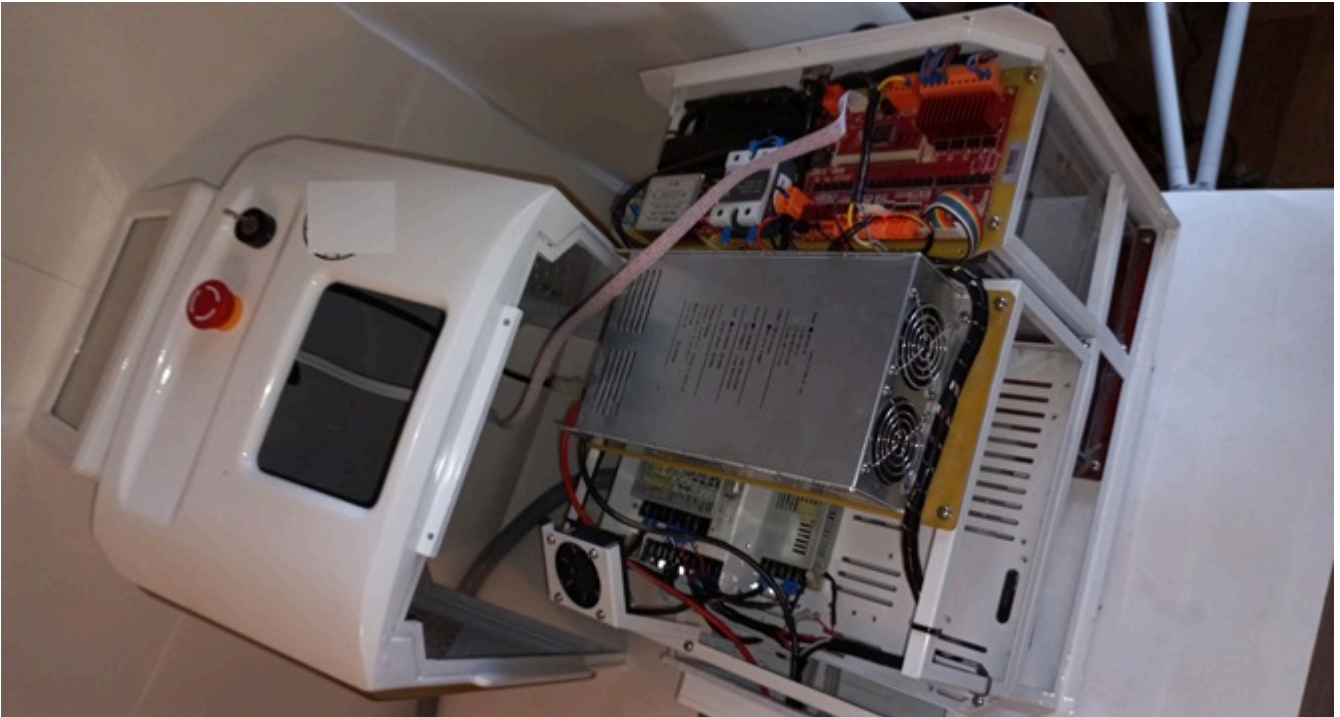
На фото ниже электронная плата данного диодного лазера. Через нее идет управление всем аппаратом.
